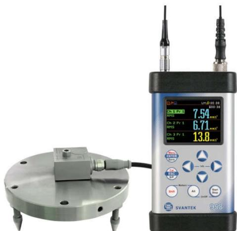
Виброизмерительный комплекс для фиксации колебаний строительных конструкций, либо грунта площадки строительства
