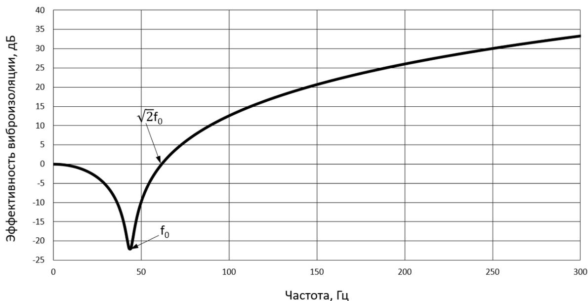
**Рисунок 7.1 – Эффективность одномассовой виброзащитной системы**
