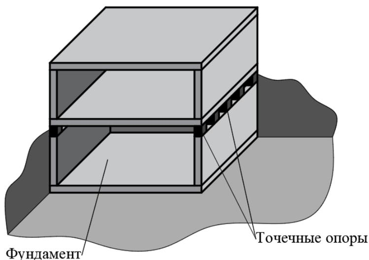
**Рисунок 8.1 – Схема виброизоляции № 1**
